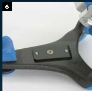
**6** Atornillar la placa adhesiva en la parte inferior de Artex.
