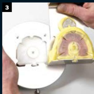
3 La placa de base Giroform está introducida. El portaimpresiones se coloca sobre el soporte de la placa.
