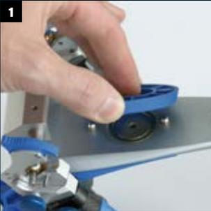
**1** Retirar la placa de modelo, el imán y la base para imán de la parte superior e inferior.
