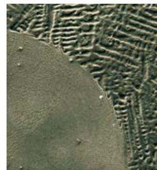
Costura de soldadura por láser exenta de fisuras en una aleación para colados de esqueléticos a base de CoCrMo y exenta de carbono
