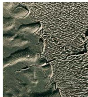
Fisuras provocadas por carburos en una aleación para colados de esqueléticos a base de CoCrMo y con contenido de carbono
