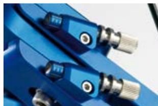
Réglage aisé et hautement précis du facteur d'agrandissement grâce aux vis micrométriques.
