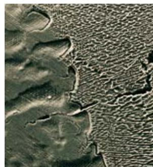
Fissures provoquées par les carbures (alliages de coulée CoCrMo contenant du carbone)
