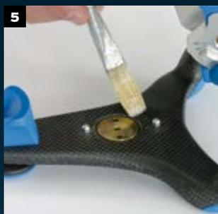
5 Isoler la surface carbone avec une fine couche de vaseline à l'endroit où l'on placera la plaque intermédiaire
