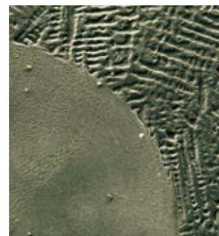
Cordon de soudure laser sans fissures (alliage de coulée CoCrMo sans carbone)
