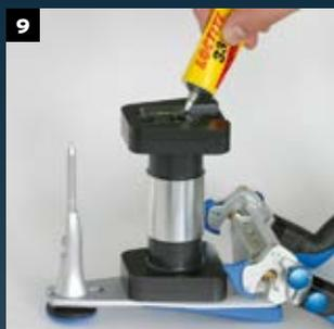
9 Appliquer une bande de colle de montage Splitex au centre de la plaque et vaporiser l'activateur sur la plaque Splitex et sur la plaque intermédiaire
