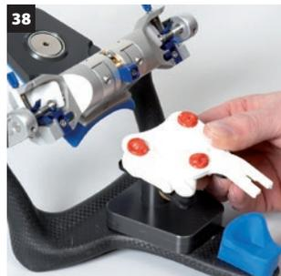
38 Артикуляционный столик в лаборатории установить в артикулятор или в гипсатор.
