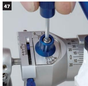
47 Прокрутите звездчатый винт, чтобы открыть начальный боковой сдвиг (ISS). Резцовый штифт не должен касаться резового столика.
