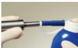
Boquilla básica y adaptador pequeño para micromotores de inducción, micromotores neumáticos y turbinas. Lubrique los micromotores neumáticos desde la parte posterior durante 1 segundo.
