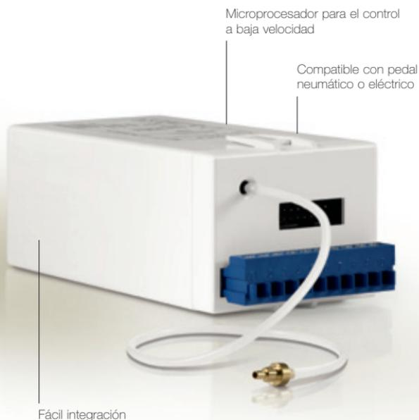
El mando PLMP 021 está especialmente diseñado para los micromotores MC3 y MC2. Controlado eléctrica o neumáticamente, gestiona una franja de velocidades particularmente amplia, de 60 a 40.000 rpm. Ello hace que los micromotores funcionen sin vibraciones ni tirones desde la velocidad más baja hasta la más elevada, en los dos sentidos de giro y con un par superior, especialmente a baja velocidad.
