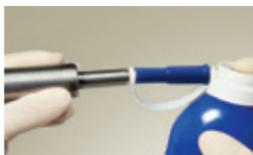
Embout de base et petit adaptateur pour micromoteurs sans balais et micromoteurs à air. Lubrifier les micromoteurs à air par l'arrière durant 1 seconde.
