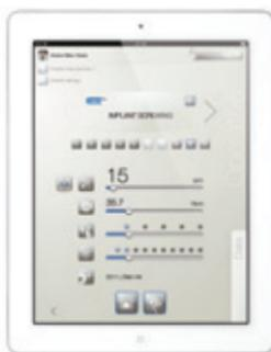
Les paramètres d'opérations sont modifiables et mémorisables en direct, pour faciliter vos interventions : vitesse, couple, sens de rotation, irrigation, éclairage, etc.
