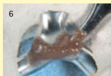
Las partículas de oro blanco influyen en el comportamiento de la fluidez de la soldadura.
