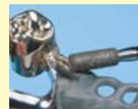
Alisado de zonas soldadas con soldadura ó láser.
