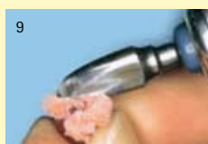
La resina de la competencia consigue la fase plástica por el calor de rozamiento al reparar y alta sensibilidad al calor. La consecuencia puede ser deformación de la modelación, superficies rugosas y ajustes imperfectos.
