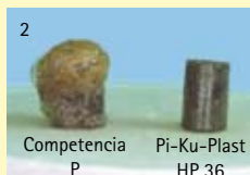
A 275°C muestra la resina de la competencia una fuerte forma de espuma y expansión.
