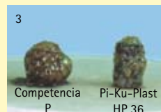
A 275°C muestra la resina de la competencia una fuerte forma de espuma y expansión.
