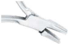
Ruhland Hohlkehlezange Magnum Zum Biegen von Coffin- und Verbindungsfedern, Labialbögen und U-Schlaufen. max. Drahtstärke: \varnothing 1,1 mm, hart
