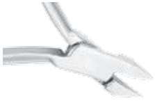
Adams Zange Medium Mit zwei Vierkantbacken, innen glatt. Mit Führungsrille. max. Drahtstärke: \varnothing 0,7 mm, hart
