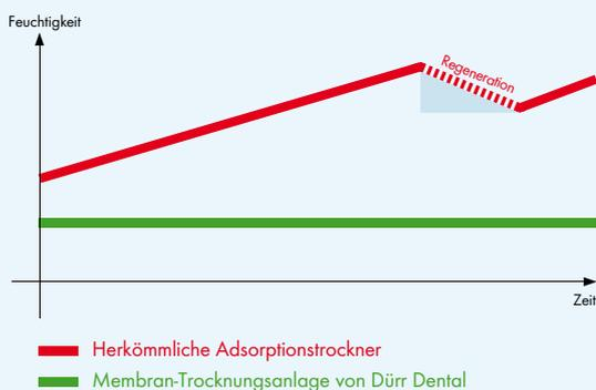
Nach längerem Betrieb des Kompressors steigt die Feuchtigkeit im Adsorptionstrockner an. Die Membran-Trocknungsanlage dagegen bleibt konstant trocken und benötigt keine Regenerationsunterbrechung.
