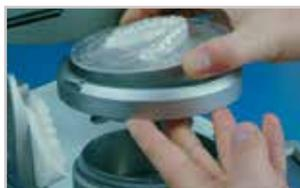
**40.** Versare il granulato nel contenitore in modo da far sporgere l'area da termoformare più 3 mm. Prestare attenzione a riempire col granulato anche le cavità sotto il modello.
