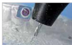
**16. Fresare con cautela** il termoformato fino ad eliminare la marcatura colorata, dei mantenitori di spazio, **non fresare eccessivamente.** (fresa in metallo duro >20 000 giri/min).
