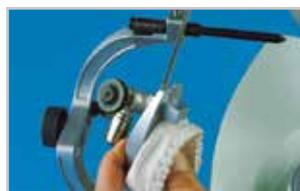
**3.** Posizionare il perno sulla linea 0 (freccia), aprire lo snodo e mettere in articolazione i modelli.
