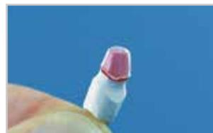
**2.** ... immergere i monconi nel granulato (granulato fine 110 861). Condensare bene il granulato, per evitare fori nei dischi e affondamento dei monconi durante la formatura.
