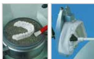
Versare il granulato nel contenitore in modo che restino visibili l'area da termoformare ...
