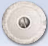
Äußerer Radius ist auf ca. 1-2 mm durchgesintert.
