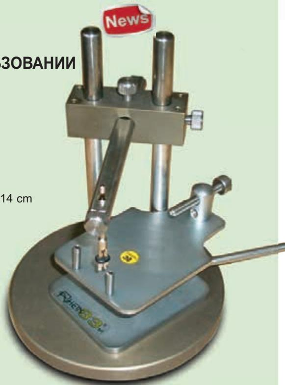
Применение этого маленького параллелометра позволяет зубному технику, имея в распоряжении простое устройство маленького размера, позиционировать аттачмены без использования фрезы, определить уровень окклюзии и многое другое.
