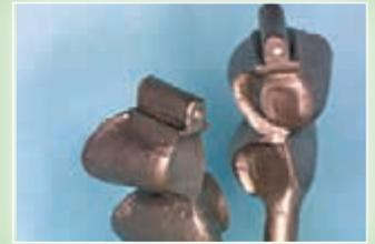
Отпескоструить отливку, удалив остатки керамики из отверстия. Использовать шаровую фрезу или соответствующую кислоту
