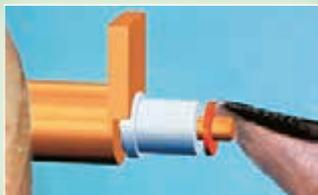
Вставить в латунный инструмент для установки керамическую формовку и прокладку из беззольной пластмассы
