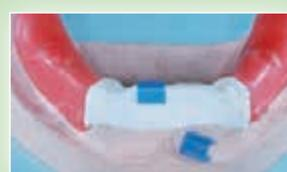
Для изолирования расположить адгезивную ленту (скотч) на «Позиционный зажим А» и на отлитую балку, установить контейнеры из беззольной пластмассы
