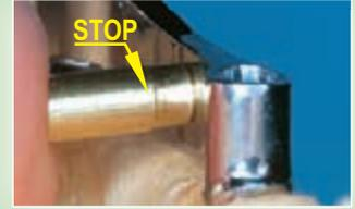
Вставить ключ для позиционирования в отверстие и зафиксировать. Пункт остановки соответствует высоте готового контейнера
