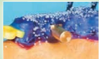
Не покрывать смолой верхнюю квадратную часть позиционирующего ключа.
