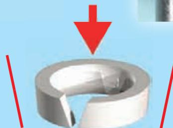
СТОПОРНОЕ КОЛЬЦО SEEGER ИЗ СПЕЦИАЛЬНОГО ЭЛАСТИЧНОГО МАТЕРИАЛА ИМЕЕТ ОПРЕДЕЛЕННОЕ НАПРАВЛЕНИЕ УСТАНОВКИ, ПОСКОЛЬКУ ОНО КОНИЧЕСКОЕ, БОЛЕЕ УЗКАЯ ЧАСТЬ ДОЛЖНА БЫТЬ НАПРАВЛЕНА К ОСНОВАНИЮ АБАТМЕНТА, СЛЕДУЯ НАПРАВЛЕНИЮ ВЫРЕЗА, СДЕЛАННОГО В ЭТОМ КОЛЬЦЕ
