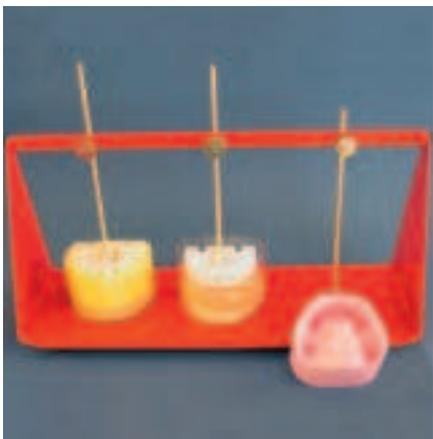
Dispositivo di fissaggio per la duplicazione senza muffola
