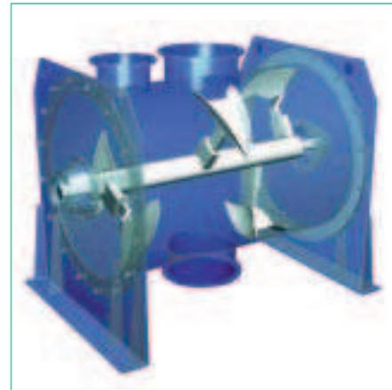
Nel miscelatore a vomere si ottiene un'elevata qualità di miscelazione dei componenti con riduzione dei tempi di processo.
